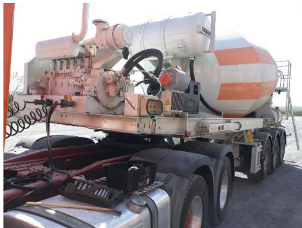
Motor independiente del camión para accionar la olla.
