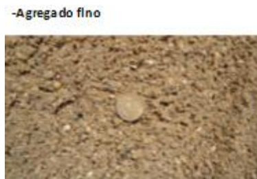
Agregado fino Arena o piedra triturada < 5 mm
