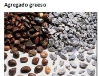
Agregado grueso Grava o piedra triturada La mayoría partículas > 5 mm En general entre 10 mm y 40 mm
