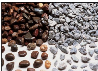
Grava o piedra triturada La mayoría partículas > 5 mm En general entre 10 mm y 40 mm
