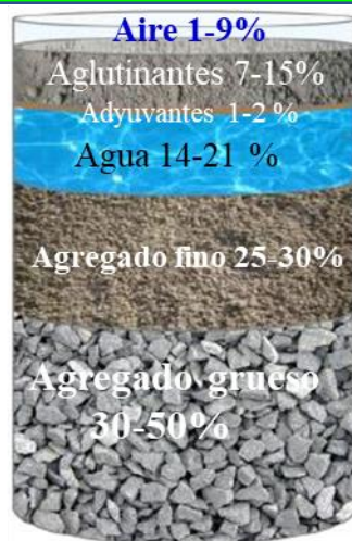
Grava o piedra triturada La mayoría partículas > 5 mm En general entre 10 mm y 40 mm
