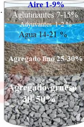
Grava o piedra triturada La mayoría partículas > 5 mm En general entre 10 mm y 40 mm
