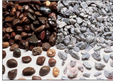
Grava o piedra triturada La mayoría partículas > 5 mm En general entre 10 mm y 40 mm
